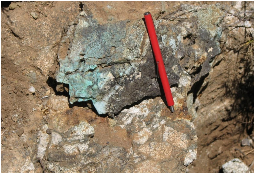
Figura 3 Brechas con óxidos de cobre y turmalina en la matriz
